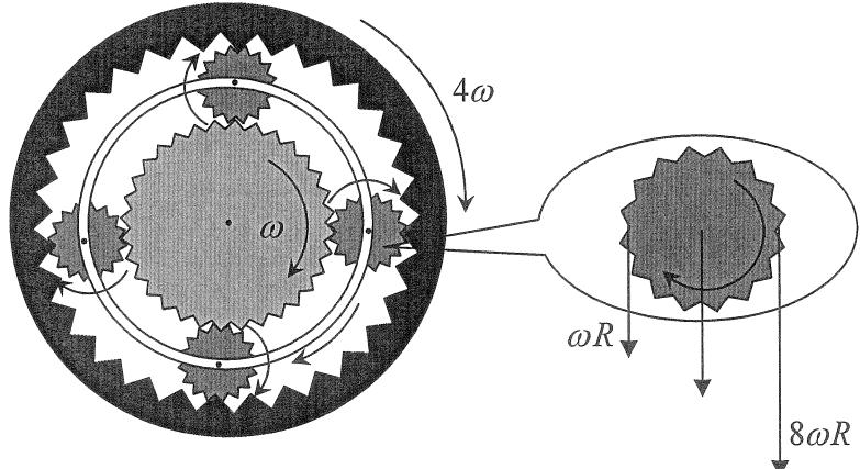
Складывая и вычитая эти уравнения, найдем линейную скорость центра спутниковой шестерни и скорость вращения точек ее поверхности в системе отсчета, связанной с центром шестерни
