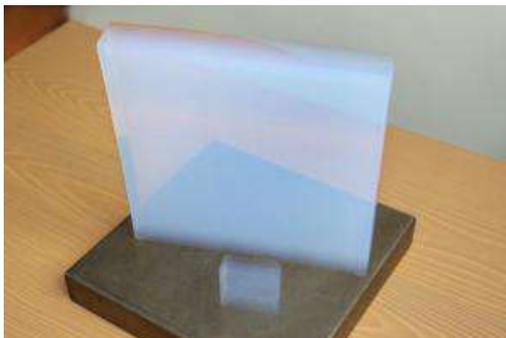
Аэрогелями называют класс аморфных высокопористых материалов, имеющих объемную макроструктуру с характерным размером наноструктурных элементов 4 – 10 нм и представляющих собой гель, в котором жидкая фаза полностью замещена газообразной.
