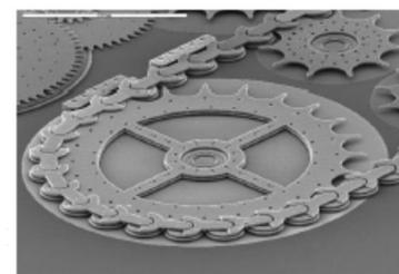
системы имеют краткое название — МЭМС. Эти устройства объединяют в себе микроэлектронные и микромеханические компоненты. В лаборатории Sandia был создан самый маленький цепной механизм (см. рис). Радиус одной шестерни  $R_1 = 180$  мкм, а другой  $R_2 = 20$  мкм.
