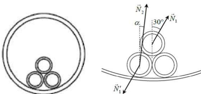
На верхнюю трубу действуют: сила тяжести и силы со стороны двух нижних труб (на рисунке показана только одна из этих сил –  $N_1$ ). Поскольку треугольник, вершинами которого являются центры малых труб, равносторонний, угол между силами, действующими на верхнюю трубу со стороны нижних, и вертикалью равен  $30^\circ$ . Поэтому из условия равновесия верхней малой трубы заключаем
