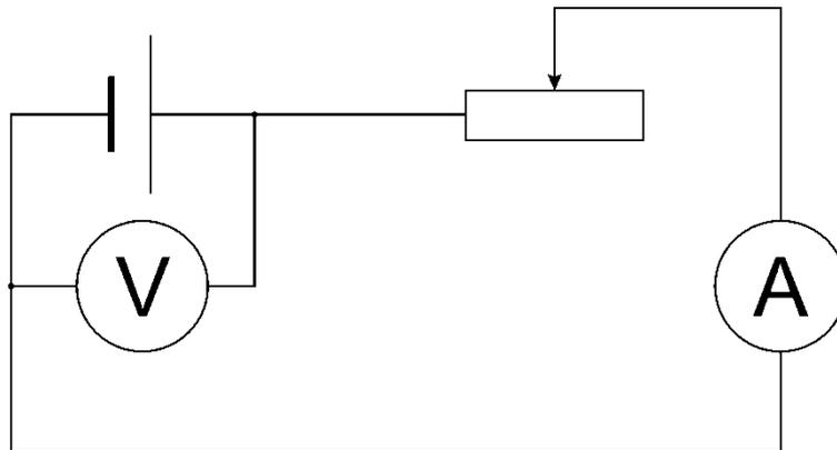
Затем строят график зависимости  $P = P(I)$  и по графику находят максимальное значение мощности. Существование максимального значения полезной мощности вытекает из анализа выражения  $P = I(\varepsilon - Ir)$ . График этой функции  $P$  от  $I$  представляет собой параболу с вершиной при  $I = \varepsilon/2r$ . Мощность при этой силе тока равна
