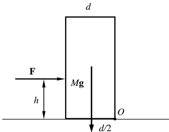
В зависимости от высоты приложения силы брусок либо начнет поступательно двигаться, скользя по поверхности стола, либо начнет опрокидываться, вращаясь относительно точки  $O$ . Из условий на силы и на моменты сил относительно точки  $O$ , получим в первом случае
