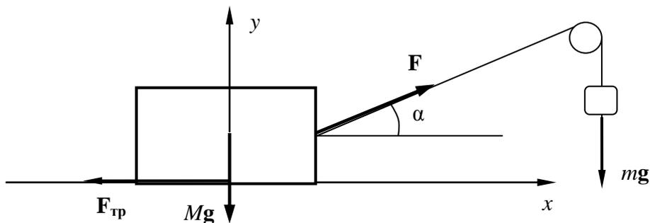
Запишем условие равновесия действующих на брусок сил в проекциях на горизонтальную и вертикальную оси.
