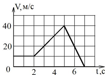
5. Тело движется по оси X, зависимость его скорости от времени представлена на графике. Определите среднюю скорость тела в интервале от 0 до 7 с.
