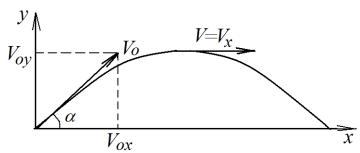
Скорость каждого тела в верхней точке траектории  $V=V_0\cos\alpha=6$ м/с. Высота подъёма каждого тела  $h=\frac{V_0^2\sin^2\alpha}{2\sigma}=5$ ,4м.
