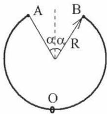
1. Проволока изогнута по дуге окружности радиуса  $R = 0,5$  м. По проволоке без трения может двигаться кольцо. Какую скорость надо сообщить кольцу, находящемуся в точке О, чтобы оно, слетев с окружности в точке А, попало на проволоку в точке В. Угол равен  $\alpha = 60^\circ$ . Ускорение свободного падения считать равным  $g = 10 \text{ м/с}^2$ . Ответ: 5 м/с
