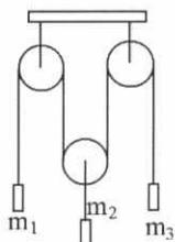
5. Через два неподвижных блока перекинута невесомая нерастяжимая нить, к концам которой подвешены два груза массами  $m_1 = 1\text{ кг}$ ,  $m_3 = 3\text{ кг}$ , а на середину нити поместили подвижный блок (см. рис.). К подвижному блоку прикрепили груз массой  $m_2 = 2\text{ кг}$ . Определить ускорение, с которым движется груз  $m_2$ . Массами блоков и трением можно пренебречь, ускорение свободного падения считать  $g = 10 \text{ м/с}^2$ . Ответ:  $-2 \text{ м/с}^2$
