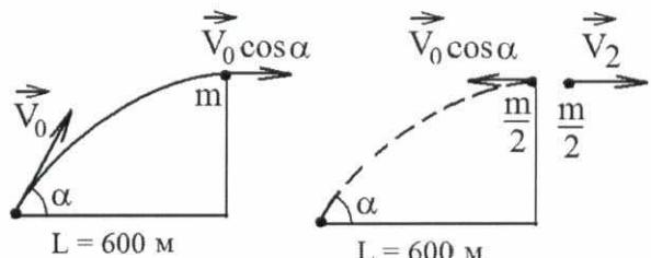
Скорость снаряда в верхней точке траектории  $V = V_0 \cos \alpha$ . Первый осколок летит в обратном направлении с прежней скоростью. Скорость второго находим из закона сохранения импульса
