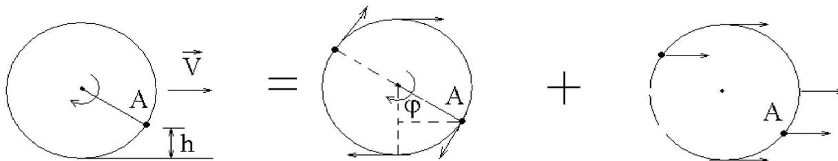
Движение колеса, катящегося без проскальзывания можно разложить на два независимых движения: вращательное относительно оси с угловой скоростью  $\omega = \frac{V}{r}$  и поступательное со скоростью  $V$ .
