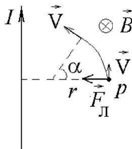
За 65 мс протон сделает два оборота и еще одну шестую оборота, при этом скорость протона отклонится на  $60^\circ$  от вертикали. Перпендикулярная проводу составляющая скорости протона будет равна
