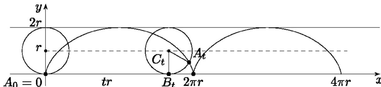
Колесо радиуса  $r = 2$  м катится по горизонтальной поверхности без проскальзывания со скоростью  $V = 1,57$  м/с. В какой-то момент  $t_0 = 0$  некоторая точка А на ободу колеса находится на высоте  $h = 1$  м от земли и движется по циклоиде вниз. Во сколько раз изменится скорость точки А относительно земли через  $t = 4$  с?
