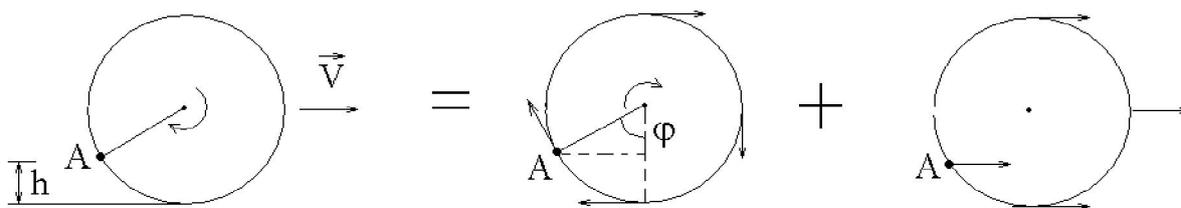
Движение колеса, катящегося без проскальзывания можно разложить на два независимых движения: вращательное относительно оси с угловой скоростью  $\omega = \frac{V}{r}$  и поступательное со скоростью  $V$ .
