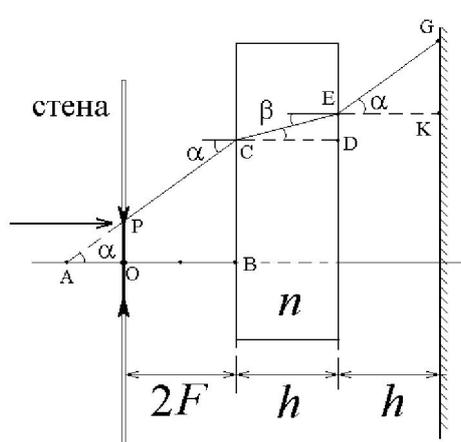
Параллельный пучок света, пройдя через рассеивающую линзу параллельно главной оптической оси, далее рассеивается так, как будто лучи выходят из мнимого фокуса слева от линзы из точки А, т.е.
