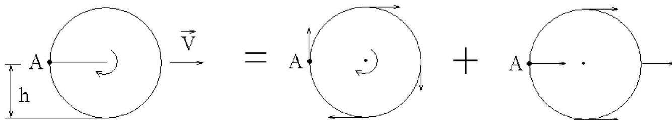
Движение колеса, катящегося без проскальзывания можно разложить на два независимых движения: вращательное относительно оси с угловой скоростью  $\omega = \frac{V}{r}$  и поступательное со скоростью  $V$ .
