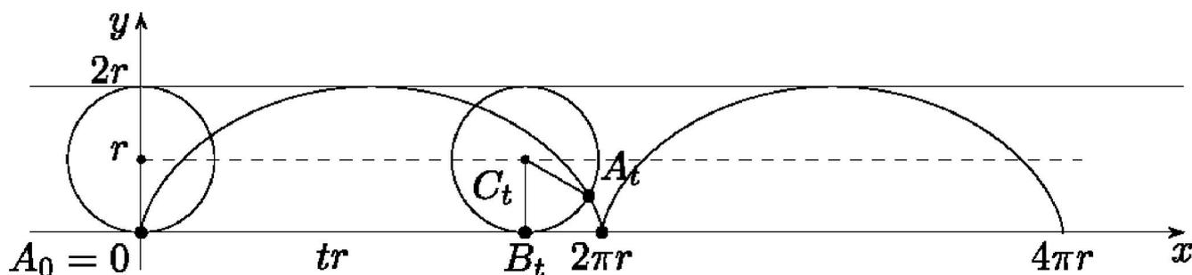
Колесо радиуса  $r = 1$  м катится по горизонтальной поверхности без проскальзывания со скоростью  $V = 3,14$  м/с. В какой-то момент  $t_0 = 0$  некоторая точка А на ободу колеса находится на высоте  $h = r$  от земли и движется по циклоиде *вверх*. во сколько раз изменится скорость точки А относительно земли через  $t = 0,5$  с?
