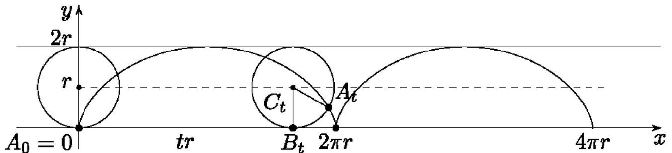
Колесо радиуса  $r = 1 \text{ м}$  катится по горизонтальной поверхности без проскальзывания со скоростью  $V = 6,28 \text{ м/с}$ .
