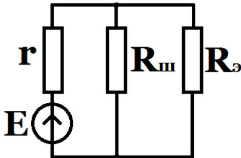
Общее сопротивление цепи:  $R_o = r + R_3 * R_{ш} / (R_3 + R_{ш})$
