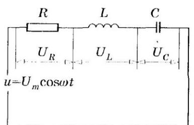
напряжением  $U = 220$  В, частотой  $v = 50$  Гц. Определите силу тока в цепи и падения напряжений на ее элементах. При какой емкости  $C$  в цепи наступит резонанс напряжений?
