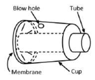
Простой воздушный рожок может быть построен путем натяжения мембраны из воздушного шарика на открытое отверстие небольшого стаканчика или чашки, через дно которого вставлено трубка (см. рисунок). Вдувая воздух через небольшое отверстие в боковой стенке стаканчика, вы можете производить звук. Изучите, какие параметры влияют на звук.
