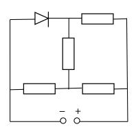
Решение. Ток через диод не течет. Эквивалентная схема изображена на рис.
