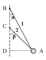
**Решение**. Обозначим: m — массу шарика, AD = r — радиус вращения,  $\alpha$  и  $\beta$  — углы, которые составляют нити 1 и 2 с осью вращения,  $T_1$  и  $T_2$ — силы натяжения нитей 1 и 2. Запишем уравнения второго закона Ньютона в проекциях на горизонтальную и вертикальную оси координат.
