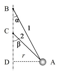
**Решение**. Обозначим: m — массу шарика,  $T_1$  и  $T_2 = 2$   $T_1$  — силы натяжения нитей 1 и 2. Запишем уравнения второго закона Ньютона в проекциях на горизонтальную и вертикальную оси координат.
