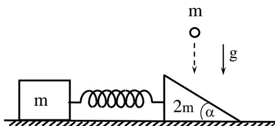
На гладкой горизонтальной поверхности расположена треугольная призма массы  $2m$  с углом  $\alpha = 30^\circ$ , соединённая невесомой недеформированной пружиной жёсткости  $k$  с бруском массы  $m$ . Шар массы  $m$  падает вертикально вниз и ударяется в призму со скоростью  $v$ . Определите
