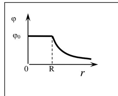
$$\varphi = \frac{\sigma \cdot 4\pi R^2}{4\pi\varepsilon_0 R}, \quad \text{откуда} \quad \sigma = \frac{\varepsilon \cdot \varphi}{R}; \quad \sigma = \frac{8,85 \cdot 10^{-12} \cdot 20}{0,1} = 1,8 \cdot 10^{-9} \frac{\text{Кл}}{\text{м}^2}.$$
