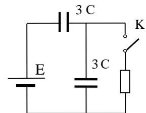
**После замыкания ключа** конденсатор  $3C$  зарядится до напряжения  $E$ , его заряд станет
