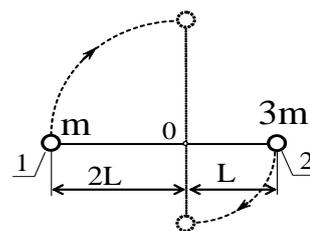
Поскольку угловая скорость  $\omega$  вращения грузов одинакова, то  $v_1 = 2\omega L$ ,  $v_2 = \omega L$ , и  $v_1 = 2v_2$  (2). Подставив (2) в (1), получим  $4v_2^2 + 3v_2^2 = 2gL$ ,  $7v_2^2 = 2gL$ , откуда
