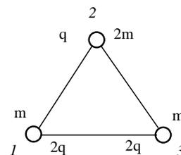
Скорости окажутся максимальными в момент  $t$ , когда все три заряда окажутся на одной прямой. При этом электрические силы будут скомпенсированы силами натяжения нити. Скорости частиц будут перпендикулярны нитям.
