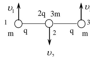
Скорости шариков 1 и 3 будут одинаковыми, обозначим их  $v_1$ . Скорость шарика 2 обозначим  $v_2$ . Из соображений симметрии и с учетом законов сохранения импульса и энергии имеем:
