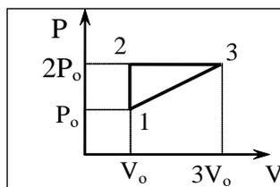
Полезная работа газа в прямом цикле пропорциональна площади цикла на графике P-V.
