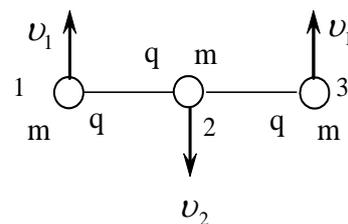
Скорости шариков 1 и 2 будут одинаковыми, обозначим их  $v_1$ . Скорость шарика 3 обозначим  $v_3$ . Из соображений симметрии и с учетом законов сохранения импульса и энергии имеем:
