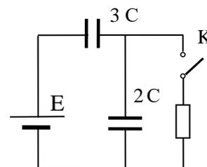
После замыкания ключа конденсатор  $3C$  зарядится до напряжения  $E$ ,
