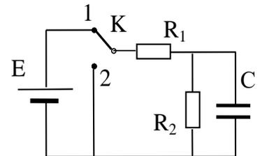
После переключения ключа  $K$  Конденсатор начнёт разряжаться через резисторы  $R_1$  и  $R_2$ . и вся энергия электрического поля, запасённая в нём, выделится в виде тепла
