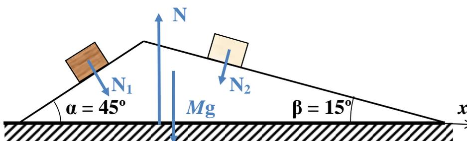
На этом рисунке показаны силы, действующие на клин. Силы давления, действующие на клин, по третьему закону Ньютона, равны силам нормальной реакции  $N_1$  и  $N_2$ . Запишем уравнение второго закона Ньютона для неподвижного клина в проекции на ось  $x$ .
