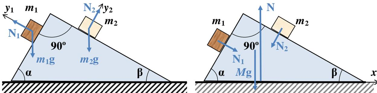
Пусть углы прямоугольного треугольника в основании клина равны  $\alpha$  и  $\beta$ . На первом рисунке показаны силы, действующие на оба тела, на втором – силы, действующие на клин. Найдем силы нормальной реакции, действующие на оба тела со стороны клина.
