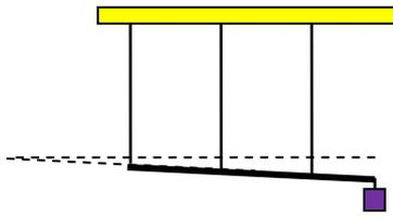
посередине между первой и третьей, то ее деформация есть точно полусумма деформаций этих нитей, или  $2x_2 = x_1 + x_3$  (см. рисунок, на котором для наглядности деформации показаны увеличенными). Нити по условию одинаковы, поэтому коэффициенты жесткости у них также одинаковы, и поэтому
