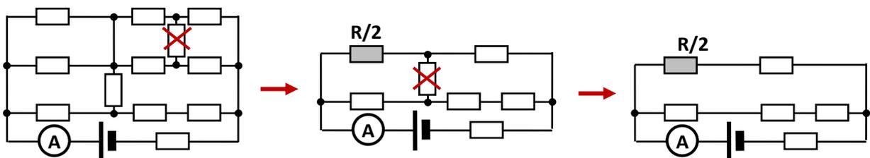
«поперечных» резисторов включен между точками с одинаковым потенциалом («правый верхний» угол схемы – сбалансированный мост). Поэтому его можно убрать из схемы без изменения токов в остальных ее элементах. После этого в верхней части образуются две пары параллельно соединенных участков, которые можно заменить на резисторы с сопротивлениями  $\frac{R}{2}$  и  $R$ . Тогда в схеме образуется еще один сбалансированный мост, и второй «поперечный»
