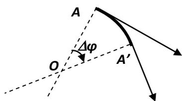
что бесконечно малый участок траектории всегда можно представить как дугу окружности, на которой вектор скорости поворачивается на тот же угол. Действительно, если на малом участке траектории длиной  $\Delta l$  вектор скорости (вместе с направлением касательной к траектории) поворачивается на угол  $\Delta \varphi$ , то мгновенный центр вращения лежит на пересечении
