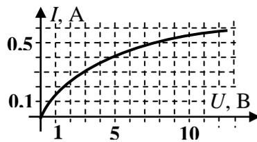
элементами – их вольтамперная характеристика показана на рисунке справа. Сопротивление резистора  $R = 28 \text{ Ом}$ , а  $E = 6 \text{ В}$ . Найти суммарную мощность, потребляемую обеими лампами.
