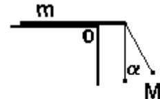
причем сила натяжения  $T$  может быть получена из второго закона Ньютона, написанного для груза в момент прохождения им нижнего положения
