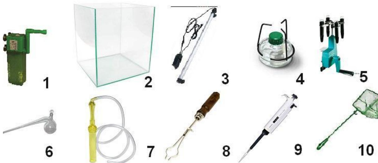
Ответ: 1. 4 - спиртовка используется как источник пламени для нагревания, прокаливания или сжигания веществ.
