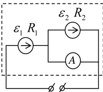
2. Школьник из двух батареек с неизвестными параметрами (ЭДС и внутренним сопротивлением) собрал источник по схеме, изображенной на рисунке, и стал её тестировать. При разомкнутых клеммах собранного источника амперметр показывал ток  $J_\infty$ , при коротком замыкании клемм ток через амперметр был равен  $J_0$ . При подключении некоторой нагрузки ток через амперметр стал равен  $J_A$ . Определите, во сколько раз сопротивление нагрузки больше внутреннего сопротивления первой батарейки.
