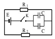
В схеме, показанной на рисунке, перед замыканием ключа К батарея, состоящая из двух одинаковых конденсаторов емкости С каждый, не была заряжена. Ключ замыкают на некоторое время, в течение которого конденсаторы зарядились до напряжения U. Определите, какое количество теплоты Q 2 выделится за это время на резисторе сопротивления  $R_1$  ЭДС источника тока равна E, его внутренним сопротивлением пренебречь.
