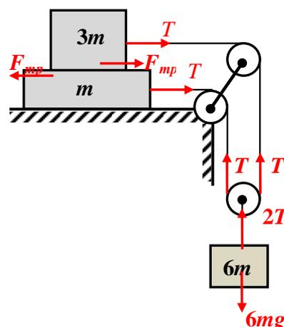
$$\begin{cases} 6mg - 2T = 6ma, \\ T - F_{mp} = ma, \\ T + F_{mp} = 3ma. \end{cases} \Rightarrow \begin{cases} a = 0,6g, \\ T = 1,2mg, \\ F_{mp} = 0,6mg. \end{cases}$$
