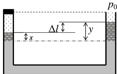
Давление воздуха  $p$  в левой части трубки найдем с помощью закона Бойля-Мариотта:
