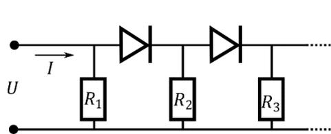
напряжением открытия, равным  $V$  (вольтамперная характеристика диода представлена на рисунке), а также резисторов с сопротивлением  $R_n = R/n$ , где  $n$  – номер звена линии, смотри Рисунок.
