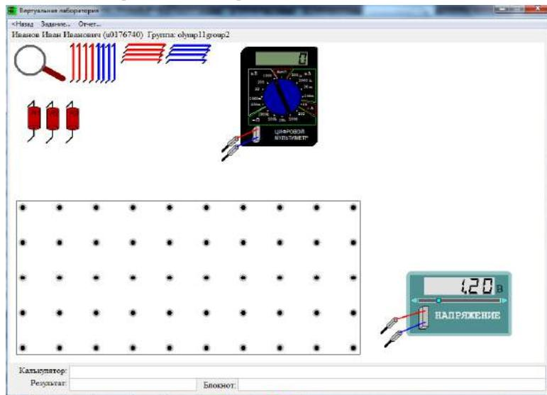
Имеются три резистора,  $R_1$ ,  $R_2$  и  $R_3$ , которые могут быть установлены на поле с контактными площадками, а также соединительные провода, источник постоянного напряжения, позволяющий устанавливать на его выходе напряжение от 0 до 5 В, и мультиметр. Найдите с максимальной возможной точностью :
