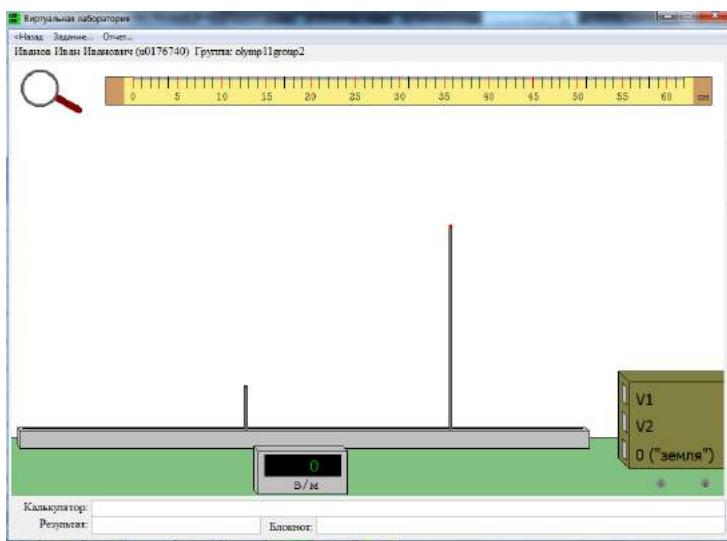
Имеется рельс, линейка, два одинаковых маленьких проводящих шарика (в правом нижнем углу) и высоковольтный блок питания: потенциал на его верхней клемме равен  $V_1=+33.4$  кВ, а на средней - некоторому значению  $V_2$ . Кроме того, имеется датчик напряженности электрического поля, реагирующий только на величину (**по модулю**) поля в его центре, но не на направление этого поля. Он закреплен на подставке, находящейся в правой части рельса и показан маленьким красным кружком.
