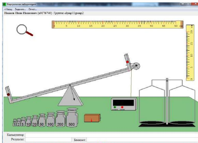
Имеется наклонный рельс с лебёдкой и датчиком натяжения нити, весы, гири, линейки и брусков.
