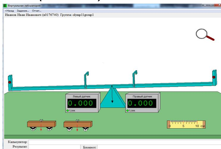
Тележки могут быть установлены на рельс. Если установить тележку на правый край рельса, включается электромагнит и удерживает её. При нажатии на красную кнопку около края рельса электромагнит отключается, и тележка начинает двигаться по рельсу без трения. Определите:
