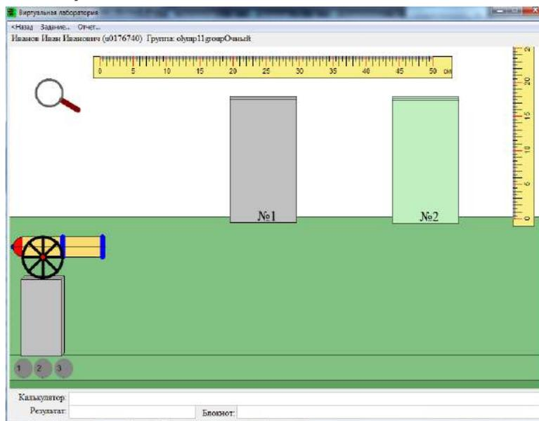
Имеется пружинная пушка, набор шариков (ядер) и бруски, которые можно вставлять в паз, вдоль которого они могут скользить, в том числе при ударе о них ядер. Энергия сжатия пружины заряженной пушки составляет  $E=0.53$  Дж. Момент полного распрямления пружины соответствует моменту вылета ядра из дула, при этом центр ядра находится на уровне среза ствола (внешней части ствола). Удары ядра о бруски абсолютно упругие.
