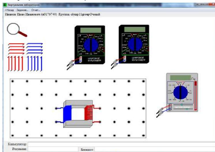
Имеется повышающий трансформатор (первичная обмотка справа, вторичная - слева) и генератор переменного напряжения регулируемой частоты. Амплитуда напряжения на его выходе меняется движком в правой части генератора. Кроме того, имеются соединительные провода и два мультиметра, которые могут работать в режиме (милли)амперметров и (милли)вольтметров - на них показывается эффективное значение напряжения или тока. Определите с минимально возможной погрешностью (желательно, не более 0.1%):
