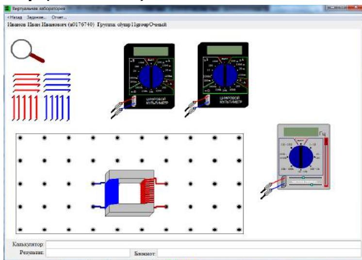
Имеется повышающий трансформатор (первичная обмотка справа, вторичная - слева) и генератор переменного напряжения регулируемой частоты. Амплитуда напряжение на его выходе меняется движком в правой части генератора. Кроме того, имеются соединительные провода и два мультиметра, которые могут работать в режиме (милли)амперметров и (милли)вольтметров - на них показывается эффективное значение напряжения или тока. Определите с минимально возможной погрешностью (желательно, не более 0.1%):
