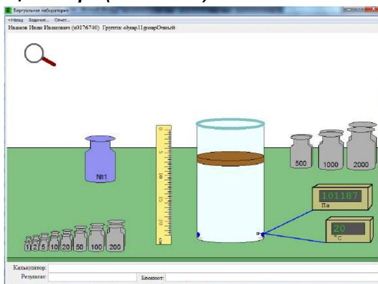
Имеется цилиндр с идеальным одноатомным газом, датчиками давления и температуры и массивным поршнем сверху, который скользит без трения, а также приборы, показывающие показания датчиков. Атмосферное давление 101 кПа. Определите:
