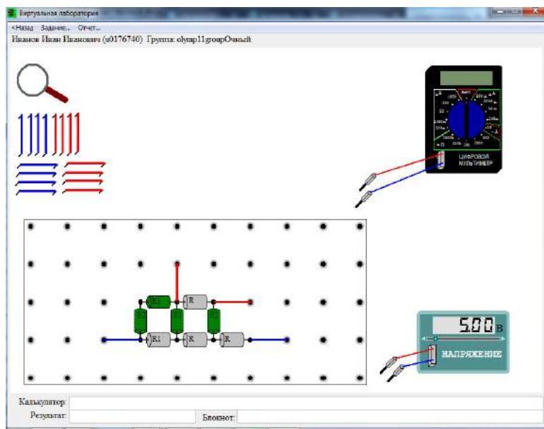
Имеются резисторы и батарейки, впаянные в плату, причём  $R_1 = R$ . Кроме того, имеются соединительные провода, источник постоянного напряжения, позволяющий менять на его выходе напряжение, и мультиметр, работающий в режиме (милли)амперметра и (милли)вольтметра. Внутреннее сопротивление батареек пренебрежимо мало. Определите с минимально возможной погрешностью (желательно, не более 0.1%):
