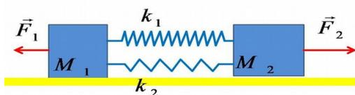
На рисунке показаны два бруска, которые могут скользить по горизонтальным направляющим. Левый имеет массу  $M_1=6$  кг, а правый - массу  $M_2=8$  кг. Коэффициент трения равен  $\mu = 0.22$ . Бруски соединены пружинами жесткостью  $K_1=300$  Н/м и  $K_2=140$  Н/м. Длина пружин в недеформированном состоянии одинакова. К левому бруску приложили горизонтальную силу  $F_1=28$  Н, направленную налево, а к правому - силу  $F_2=138$  Н, направленную направо (см. рис.) Определите:
