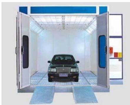
Морусевым К.Г. принято решение о расширении своего бизнеса. Для чего планируется установка новой трехфазной окрасочно-сушильной камеры (общей установленной мощностью 27 кВт), взамен установленной камеры мощностью 15 кВт (коэффициент мощности принять равным 1).
