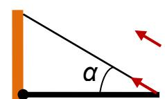
**Решение задачи:** При поступательном движении кубика с постоянной скоростью сумма приложенных к нему сил равна нулю. На рисунке синим цветом показаны силы, действующие на кубик. Используя условие равенства нулю проекции суммы сил на направление вдоль
