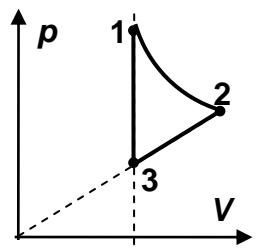
**Ответ на вопрос:** Рассмотрим расширение газа от объема  $V_1$  до  $V_2$ . Работа газа равна площади под диаграммой процесса в координатах  $p$ - $V$  (площади трапеции), то есть
