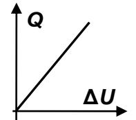
При этом изменение температуры, в соответствии с уравнением Менделеева-Клапейрона  $\Delta T = \frac{1}{\nu R}(p_2 V_2 - p_1 V_1) = \frac{\alpha}{\nu R}(V_2^2 - V_1^2)$ , и поэтому  $A = \frac{\nu R}{2} \Delta T = \frac{1}{3} \Delta U$ . Количество теплоты  $Q = A + \Delta U = \frac{4}{3} \Delta U$ . График показан на рисунке.
