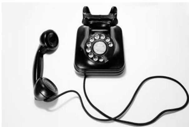
Для такого телефонного аппарата (с дисковым номеронабирателем) набор номера абонента осуществляется следующим образом: при вращении диска по часовой стрелке до пальцевого упора контакты номеронабирателя замыкают линию, а при возвратном вращении линия размыкается такое число раз, которое соответствует набранной цифре. На рисунке показана временная диаграмма работы телефонного аппарата.
