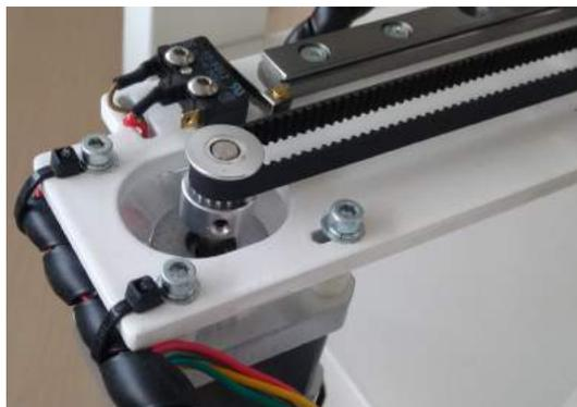
Ось X 3D-принтера приводится в действие шаговым двигателем NEMA17 с вот такими параметрами:
