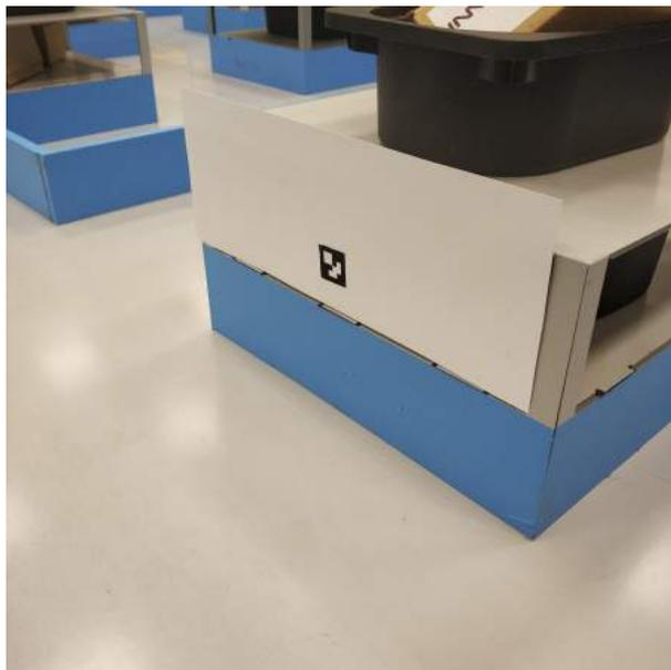
Рис. 6.5: Стеллаж с установленным ARTag маркером
