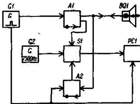
Тактовый генератор  $G1$  управляет взаимодействием узлов прибора и обеспечивает его работу в автоматическом режиме. Генерируемые им короткие (0.1 с) прямоугольные импульсы положительной полярности повторяются каждые 10 с.
