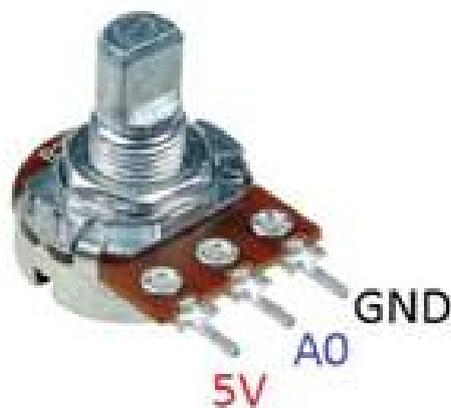
Рис. 1 Схема подключения потенциометра.
