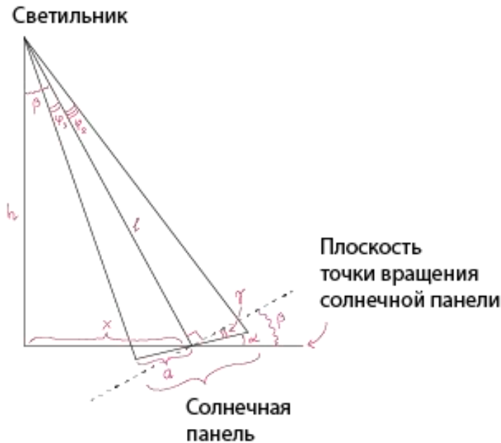
Рис. 2. Обозначения геометрической задачи нахождения углового размера солнечной батареи в поле зрения источника света
