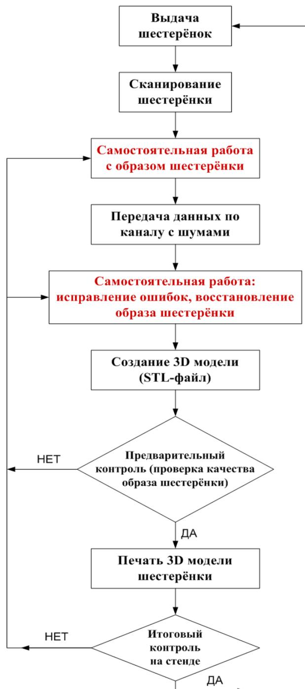
**Блок-схема работы на стенде «Технологии беспроводной связи»**
