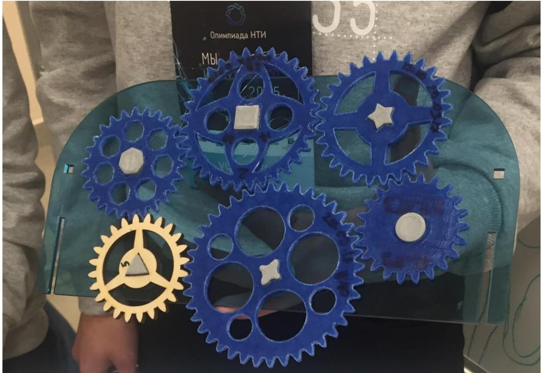
*Макет коробки передач с 3D-печатными копиями шестеренок*
