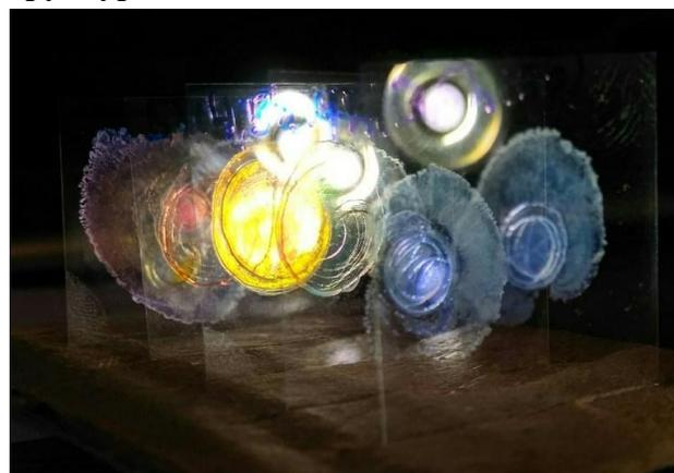
Пробы, отобранные на этапе 2 по каплям, наносят на покровные стекла, высушивают и наблюдают иризацию с помощью фонарика. Для нанесения необходимо капнуть одну каплю раствора на стекло, дождаться его растекания и подуть до полного высыхания. Результаты подобного способа нанесения приведены на рисунках. Необходимо получить 10 стекол с образцами, по 1 на каждую отобранную пробу (9) и 1 для конечного золя.
