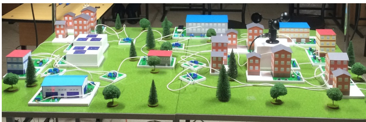
Рисунок 2. Цифро-натурный стенд игры «Энергосистема»
