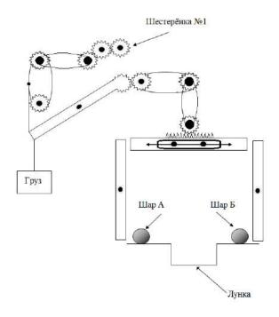
На рисунке изображен механизм, состоящий из вращающихся шестеренок, ременных передач, рычагов, рейки с зубьями и груза на веревке.
