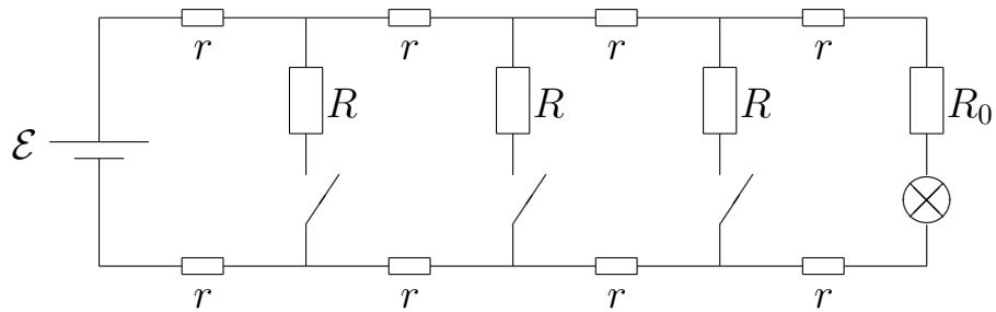
Комплекс светильников имеет общее рабочее сопротивление  $R_0 = 1100$  Ом и питается от специального источника питания, ЭДС которого  $\mathcal{E} = 500$  В. Сопротивление каждого сегмента основного кабеля  $r = 0.03$  Ом, сопротивление каждого цехового кабеля (с рубильником)  $R = 600$  Ом, внутренним сопротивлением источника можно пренебречь. Количество цехов  $N = 97$ .
