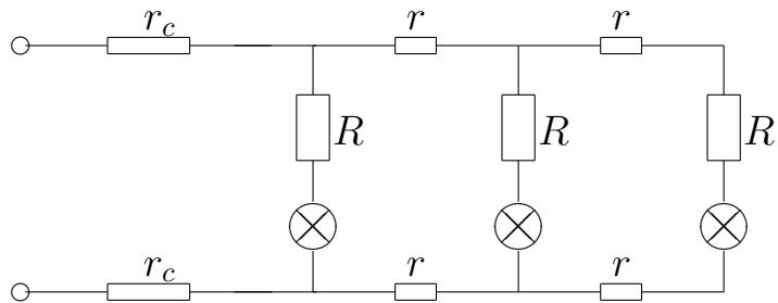
Все лампы одинаковы и питаются от стандартной электросети с напряжением  $U = 220$  В. Рабочее сопротивление каждой лампы (вместе с подводящими проводами)  $R = 900$  Ом, сопротивление каждой из двух жил, идущих между соседними буквами,  $r = 0.03$  Ом, а сопротивление каждой из двух жил, соединяющих первую букву с источником питания,  $r_c = 3$  Ом.
