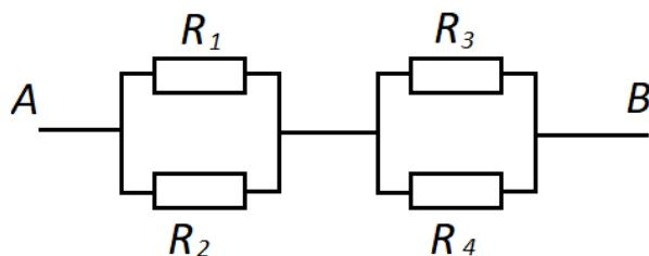
$$\text{Её общее сопротивление: } R = \frac{R_1 R_2}{R_1 + R_2} + \frac{R_3 R_4}{R_3 + R_4} = \frac{1 \cdot 2}{1+2} + \frac{3 \cdot 4}{3+4} = \frac{50}{21} \approx 2,38 \Omega \text{ (5 баллов).}$$
