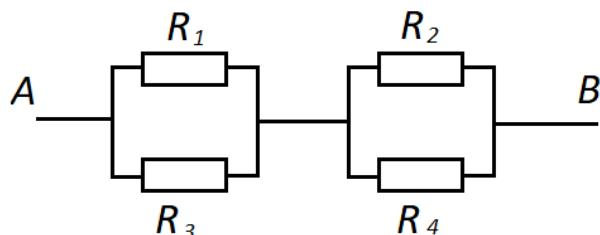
$$\text{Её общее сопротивление: } R = \frac{R_1 R_3}{R_1 + R_3} + \frac{R_2 R_4}{R_2 + R_4} = \frac{1 \cdot 3}{1+3} + \frac{2 \cdot 4}{2+4} = \frac{25}{12} \approx 2,08 \Omega \quad (5 \text{ баллов}).$$
