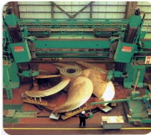
Станок для обработки гребных винтов
