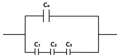
где  $C_1$  – емкость части конденсатора над полостью,  $C_2$  – емкость полости,  $C_3$  – емкость части конденсатора под полостью,  $C_0$  – емкость оставшейся части конденсатора за пределами выделенной области. **(6 баллов)**
