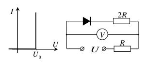
потенциала происходит в направлении стрелки в обозначении диода. Построить график зависимости показаний вольтметра  $U_v$  в зависимости от напряжения на входе цепи U. Найти показания вольтметра при напряжении на входе цепи  $5U_0$  (разной полярности). Сопротивления резисторов даны на схеме.
