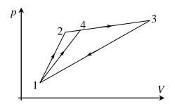
**4.** С идеальным газом проводят циклический процесс 1-2-3-1, график которого в координатах «давление-объем» представляет собой треугольник, причем прямые 1-2, 2-3 и 1-3 являются возрастающими (см. рисунок). Известно, что термодинамический КПД процесса 1-2-3-1 равен  $\eta$ . Найти КПД процесса 1-4-3-1, если прямая 1-4 делит отрезок 2-3 на части, длины которых 2-4 и 4-3
