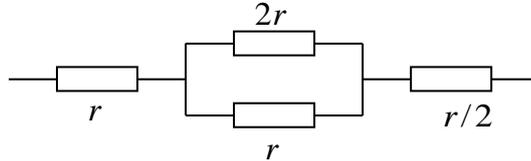
Здесь левый резистор  $r$  - сопротивление одной трети стержня с бóльшим удельным сопротивлением, верхний резистор  $2r$  - сопротивление двух третей стержня с бóльшим удельным сопротивлением, нижний резистор  $r$  - сопротивление двух третей стержня с меньшим удельным сопротивлением,  $r/2$  - сопротивление одной трети стержня с меньшим удельным сопротивлением. А поскольку сопротивление стержня с меньшим удельным сопротивлением равно  $R$ , то
