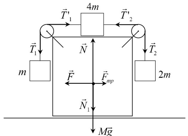
где  $T_1$  и  $T_2$  - силы натяжения левой (связанной с меньшим грузом) и правой нитей соответственно,  $F_{mp}$  - сила трения. Таким образом, чтобы найти силу  $F$ , надо найти силы натяжения нитей и силу трения.
