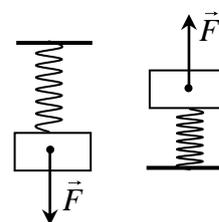
к силе тяжести, действующей на груз. **Указание.** Удлинение пружины пропорционально действующей силе (закон Гука).
